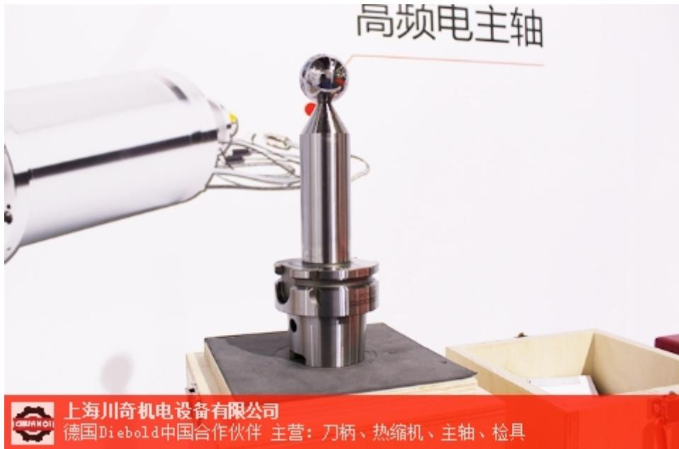
德国Diebold戴博检棒也称为测试芯棒主要用来检查主轴套筒类零部件的径向圆跳动，轴向窜动，同轴度，平行度及其与导轨的平行度等精度项目。Diebold主轴检测棒可分为：五轴机床专用球头检棒、三轴机床用非球头直棒、BT/SK大锥度主轴检棒、D-BT锥度主轴检棒、HSK主轴检棒、PSC主轴测试芯棒（Capto接口）。
